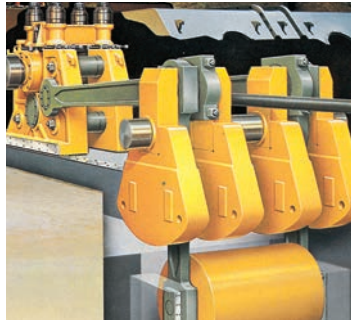
Özel oynak makaralı rulmanlarla kaynaklı haddeleme borusu için soğuk pilger makinesi
